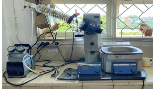
Gambar 9. Alat rotary vacuum evaporator (rotavapor) (Dokumentasi Pribadi)
